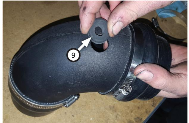
2. Deburr hole then install **grommet (9)**.
